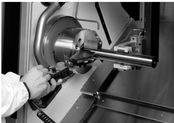
図4 パルスハンドルによるロボットの手動操作
