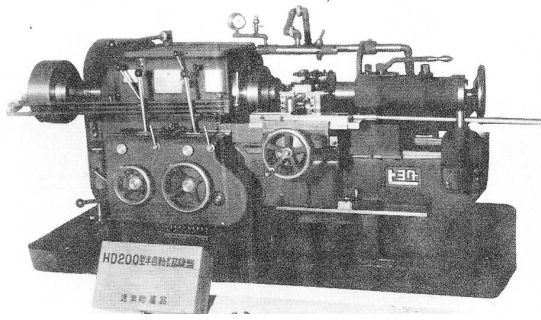
写真2 超硬工具性能試験に使ったHD200型 半自動多刃旋盤(豊田工機)
