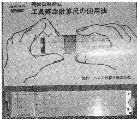
写真3 機械試験所式工具寿命計算尺
